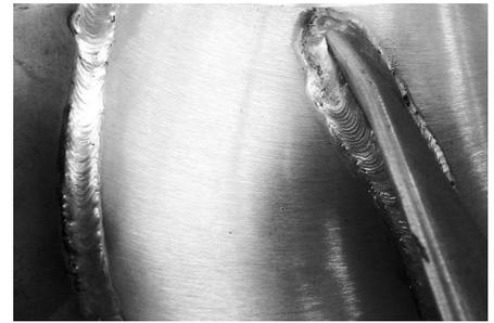
Abb. 11. Laufrad-Schweißnaht
