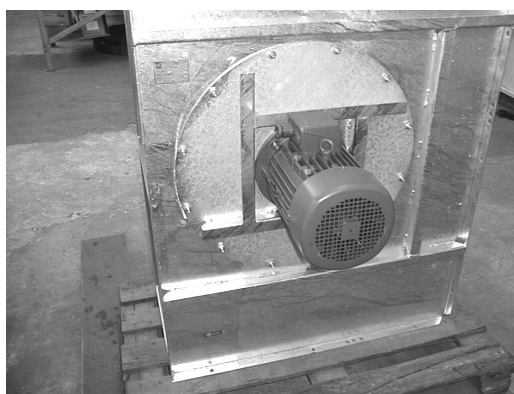
Figuur 1. Motor gemonteerd tegen de zijplaat
