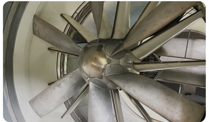
2 Meter großer ZerAx-Ventilator, bereit zur Installation
